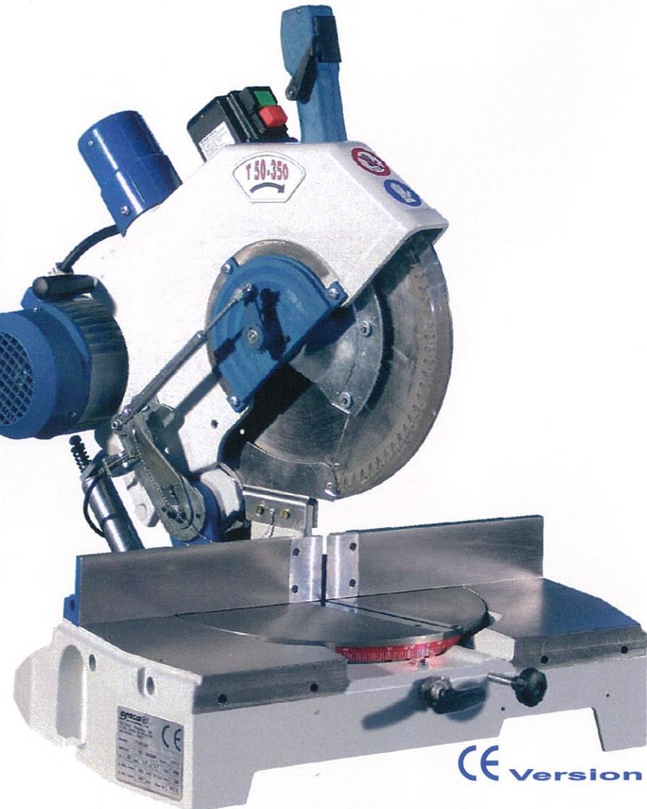
**troncatri ci orientabili di precisione** con tavola rotante e bloccaggio autozentrante per le angolazioni principali 90°, 45°, 30°, 22.30°, 15°, 10° destra e sinistra; bloccaggio manuale per tutte le altre angolazioni intermedie, con lettura sul settore graduato.
