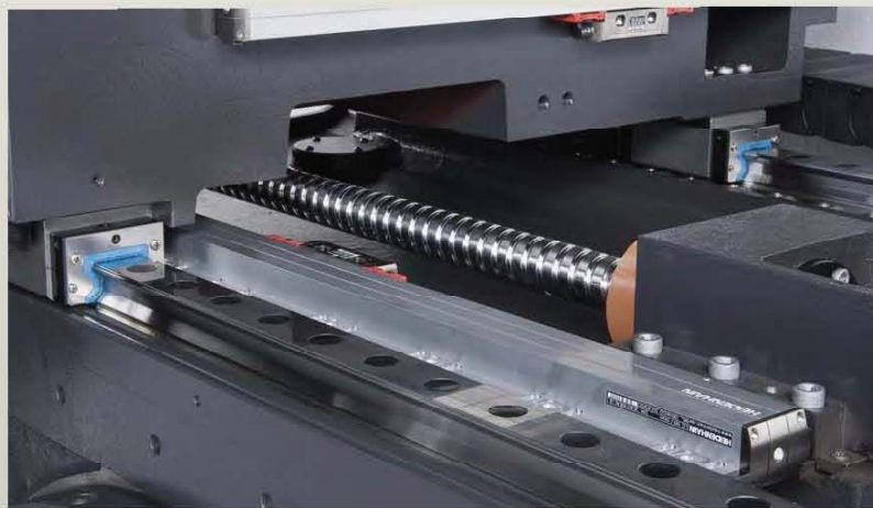
Optional 3 Axes Linear Scales OP
